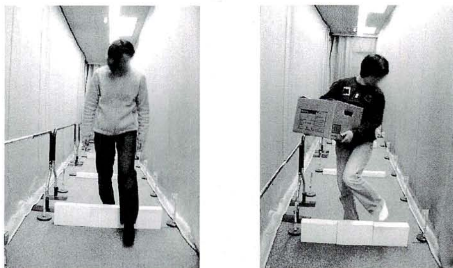
図 2.8.2 またぎ段差計測風景
