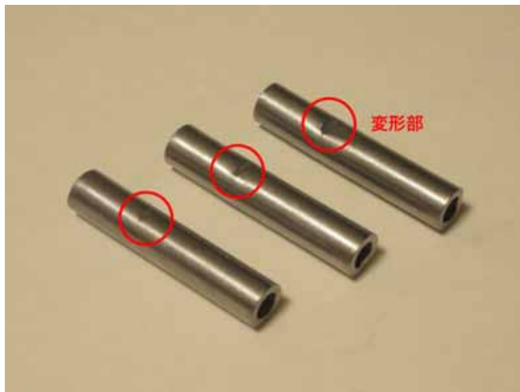
図 2.13 ダミー実験の結果：速度が異なる建具にはさまれた時の変形の様子 (図中の丸印が変形部)
