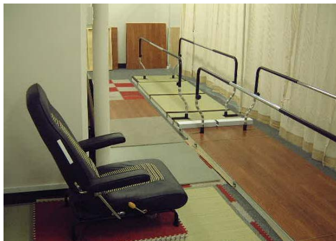
図 2.12.1.1 床面の滑り感計測用歩行路
