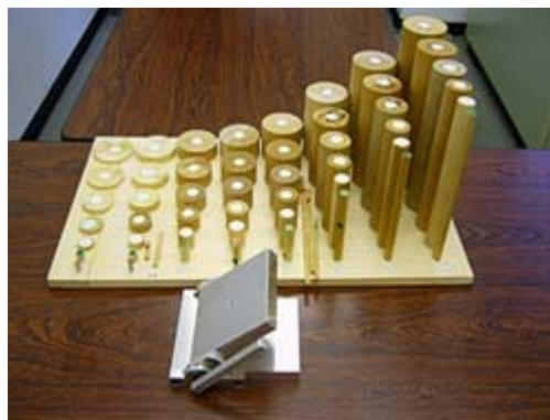
図1-1 実験装置：円柱56種類と治具（手前）
