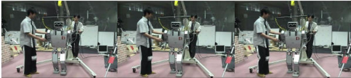
図3 - 4 - 16 ヒューマノイドロボットによる歩行検証
