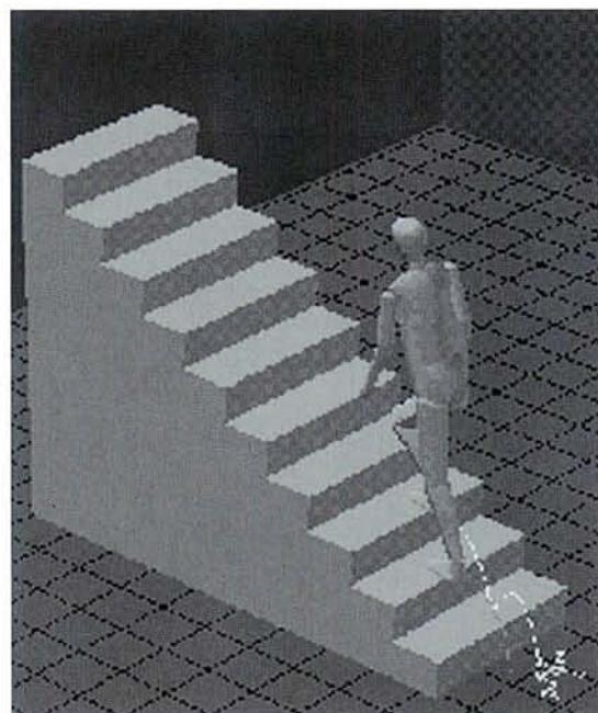
図6 動態モデル（階段を昇る動作の再現）
