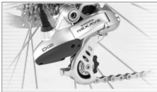
写真7 Di2 リアディレイラーシステム 電子制御により作動し、静かでショックのないギアチェンジ
