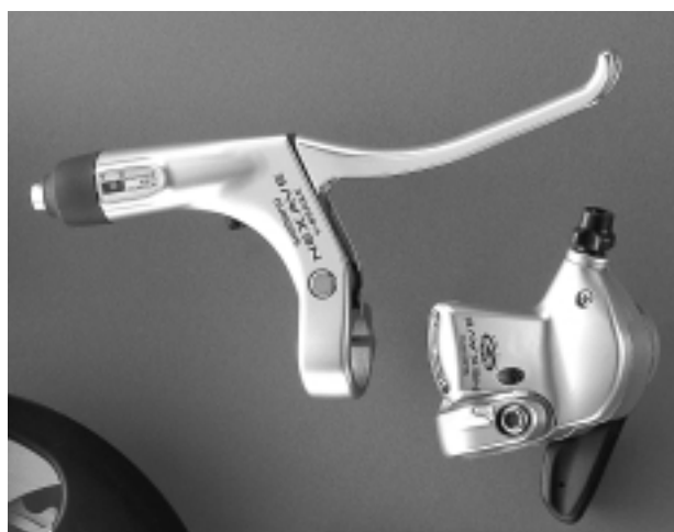
写真4 パワーモジュレーターをブレーキレバー部に内蔵したネクサーブC900ブレーキレバー
