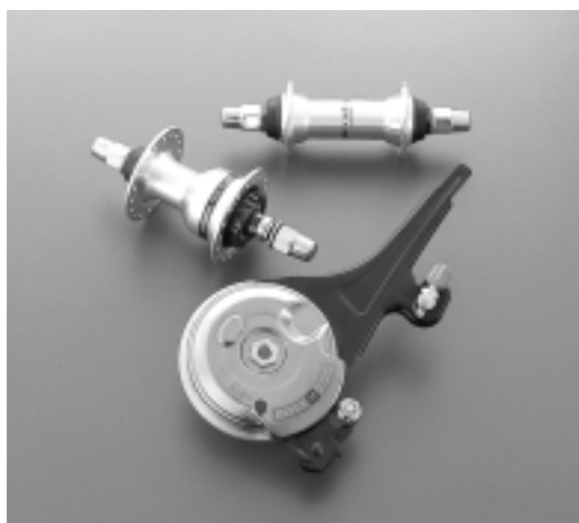
写真3 内蔵式で雨の日もブレーキ力が晴天時とほぼ同じで使いやすいローラーブレーキ 前ブレーキにはパワーモジュレーターを内蔵し、急な飛び出しなどで、ブレーキレバーを咄嗟に引っ引いてもモジュレーターの働きで、ブレーキ力を制御し、前輪のロックを未然に防ぎます
