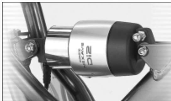
写真8 Di2 リアエアサスペンション フロントとともにコンピュータコントロールのサスペンションシステムを形成
