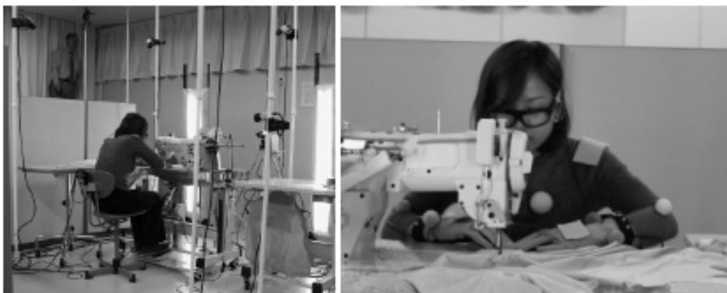
図2 ミシンによる縫製作業の行動計測実験
