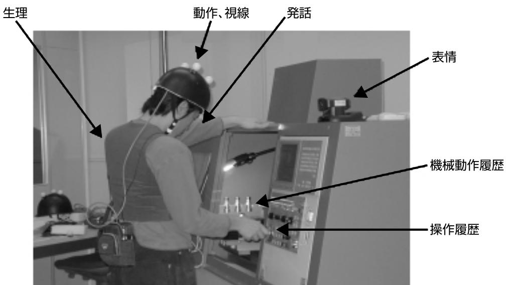
図4 NC工作機械による機械加工の行動計測実験
