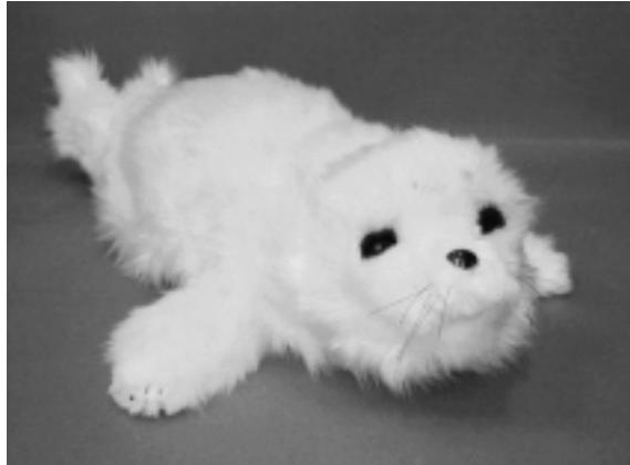
図1 アザラシ型メンタルコミットロボット「パロ」
