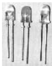
図1 市販されている砲弾形 LED 光源の商品例 樹脂部外形：約 \phi 5 mm。発光素子（LED チップ）約 \square 0.3 mm の立方体は、樹脂部のほぼ中央部にモールドされている
