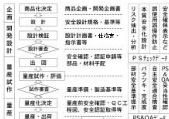
図7 製品開発のPS & QAフローチャート
