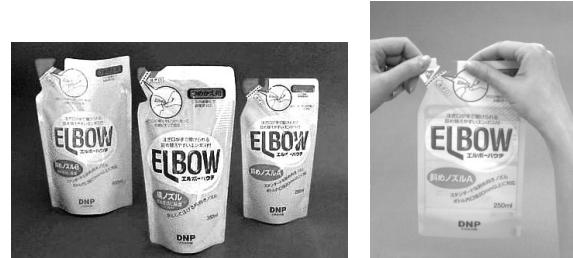
詰め替えパウチも、様々な形状のものが登場しているが、注ぎ出し部の形状を工夫することでその部分を開封することが直感的にわかるものである。さらに開封部は、指でつまむ際に、十分な大きさを備えたサイズで、はさみを使わずに手でまっすぐ開封できるような加工が施されている。また内容物をスムーズに注ぎ出せるように閉塞しないための加工も行っている。使用後は、減容化でき廃棄のことにも配慮している。
