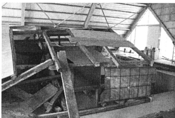
図6 倒壊家屋実験施設
