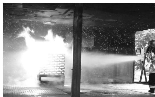
写真2 流体方式のウォータミストノズルによる消火実験
