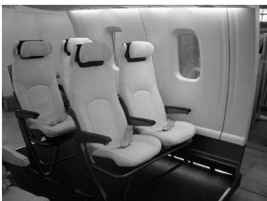
図4 薄型シートと評価用モックアップ
