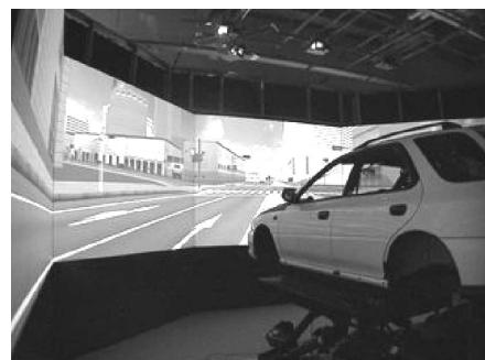
図6 ドライビングシミュレーターによる事前検証の様子（慶應大学川嶋研究所）
