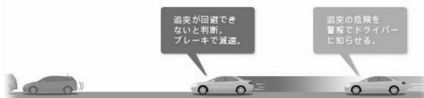
図8 体感ブレーキ警報の動作イメージ<sup>4)</sup>
