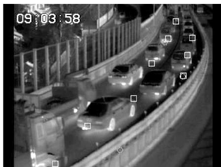
図8 AHS画像処理センサーの処理画面（赤外画像処理センサーの例）
