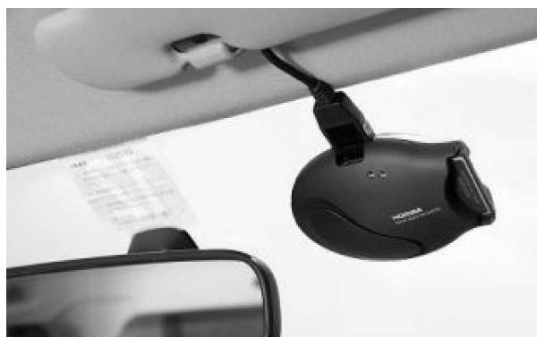
図2 ドライブレコーダ「どら猫」(取り付け状態)
