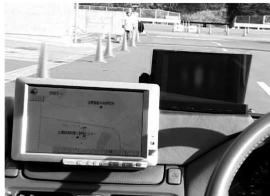
図6 一旦停止交差点への通常の減速行動からの逸脱検知システム
