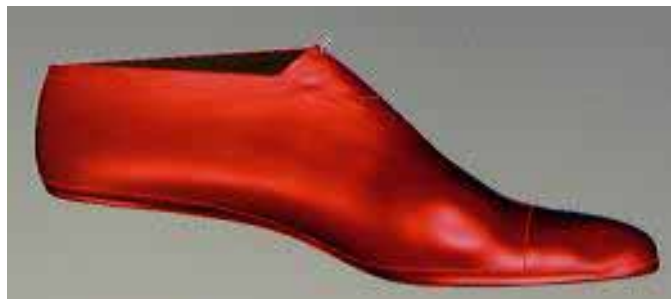
図3 - 3 - 2 足部の精密な相同モデルを用いた試作靴の靴型データ
