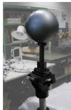
図3-2-2 キャリブレーション用治具イメージ図
