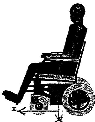
図4.3.6-3 後輪駆動のモデル<sup>1)</sup>
